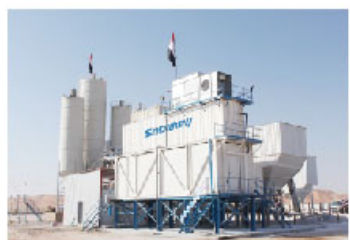
混凝土冷却 (片冰、管冰、冷水)
